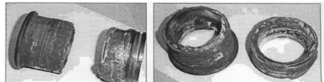
Рисунок 5 – Втулка пускового подшипника после разрушения
