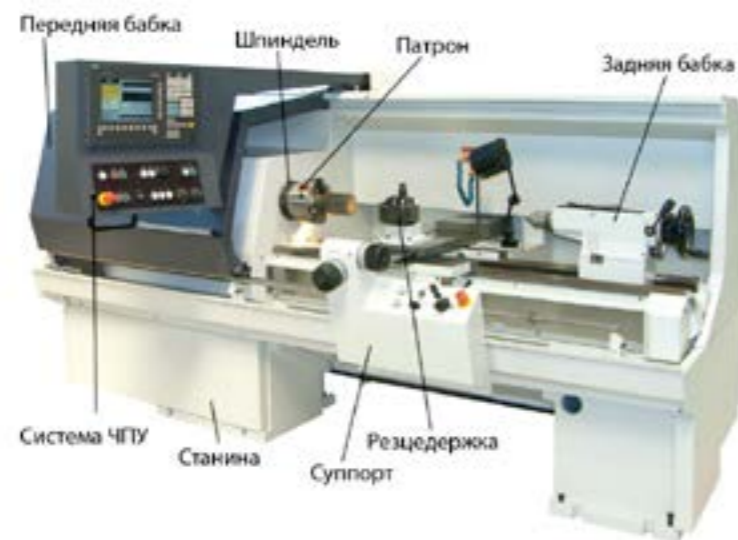
Рисунок 1 – Узлы токарного станка
