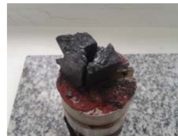
Рисунок 3 – Разрушение катодного образца при комнатной температуре
