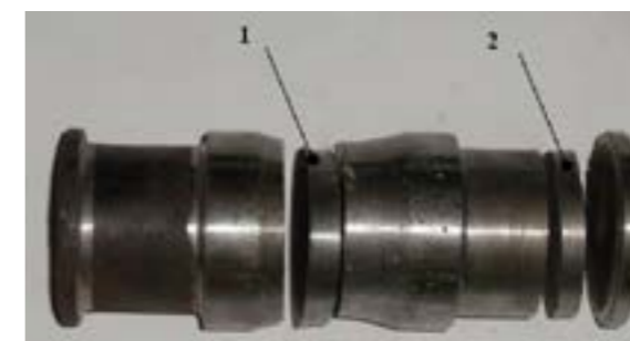
Рисунок 6 – Валик: 1 – срез в сечении нового валика, 2 – срез в сечении восстановленного валика
