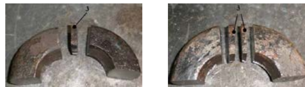
Рисунок 7 – Тяга центрального рессорного подвешивания: 3 – срез в сечении новой тяги, 3 – срез в сечении восстановленной тяги
