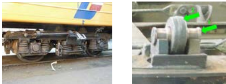
Рисунок 1 – Детали рессорного подвешивания: 1 – валик, 2 – тяга центрального рессорного подвешивания
