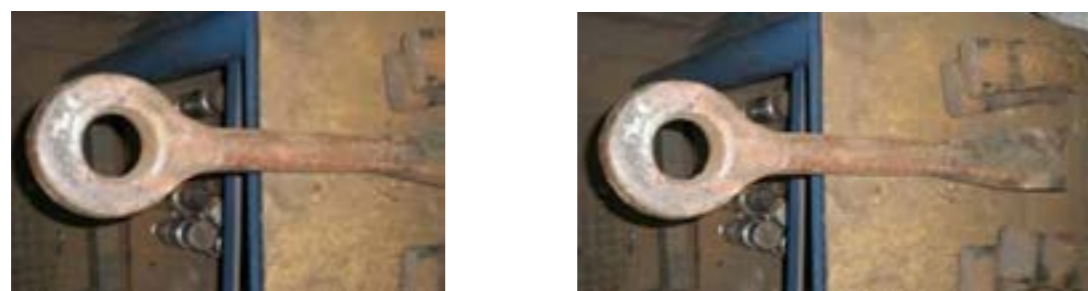
Рисунок 5 – Тяга центрального рессорного подвешивания: a – новая, b – изношенная
