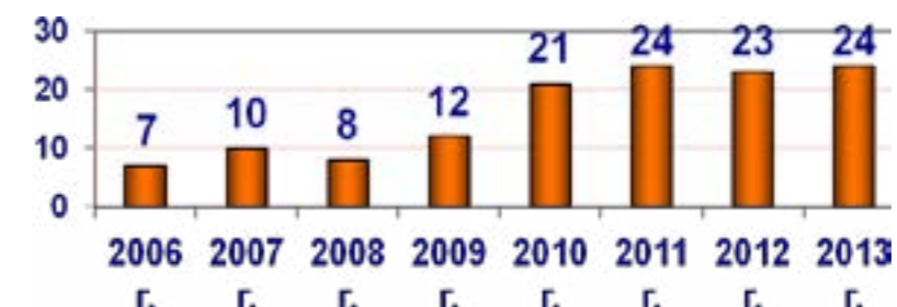
Рисунок 1 – Анализ изломов литых деталей тележек с 2006 – сентябрь 2013 гг
