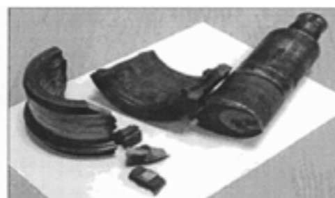
Рисунок 8 – Корпус уплотнения и вал с усталостной трещиной. Вид 2
