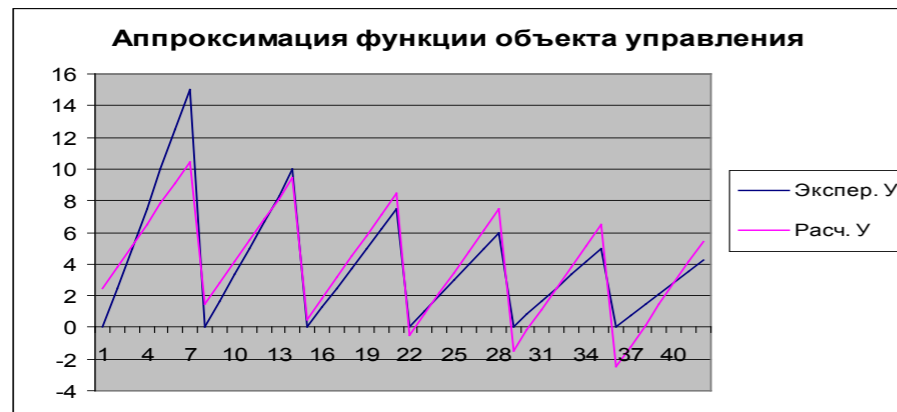
Рисунок 3 – Графики экспериментальной (эмпирической) и расчетной функции объекта управления
