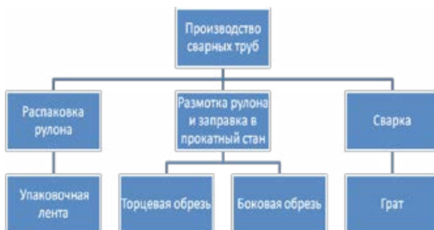
Рисунок 1 – Схема технологического процесса производства сварных труб с точками возникновения отходов
