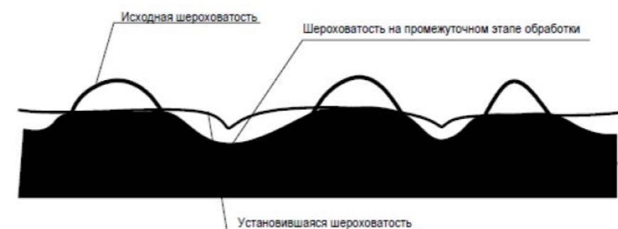
Рисунок 1 – Образование профиля установившейся шероховатости
