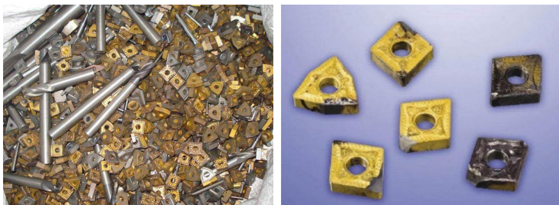
Рисунок 1 – Изношенные твердосплавные пластины
