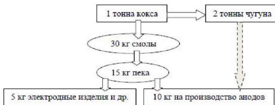
Рисунок 2 – Схема баланса производства пека
