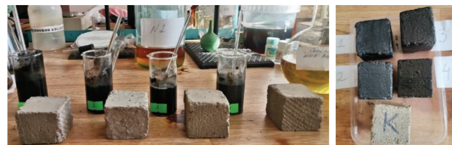
Рисунок 8 – Процесс изготовления полимерного покрытия с наполнителем микрокремнеземом
