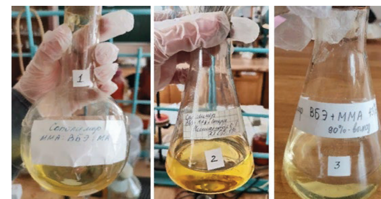
Рисунок 4 – Готовые сополимерные материалы для создания покрытия
