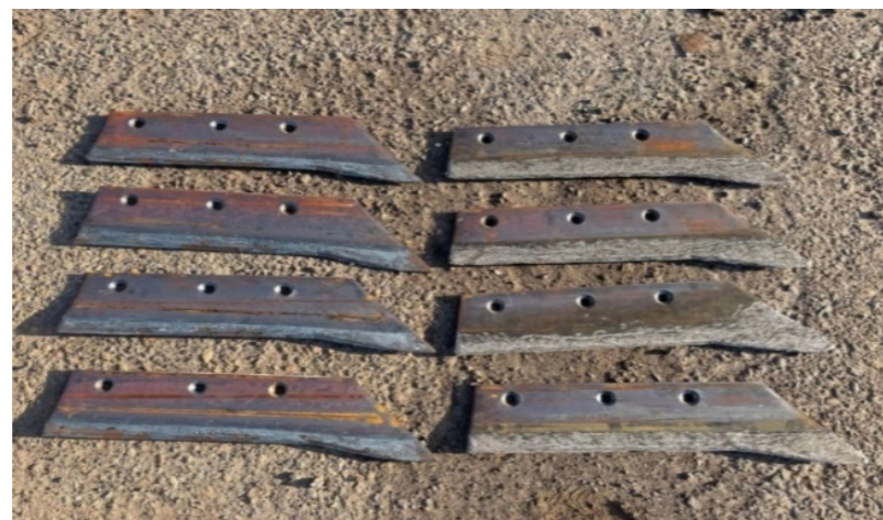
Рисунок 4 – Вид лемехов до и после ЭФУ (слева лемеха с наплавкой сормайтa, справа лемеха с комбинированный обработкой ЭФУ поверх наплавки из сормайтa).
