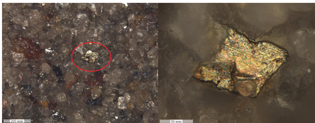
а) б) Рисунок 3 – Морфология поверхности лежащих хвостов Майкаинской обогатительной фабрики
