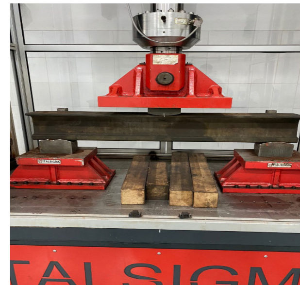
Сурет 1 – Рельстердің төзімділік шегін анықтауға арналған үлгі
