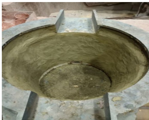
Рисунок 4 – Нанесенная защитная обмазка на основе молотого боя шамота
