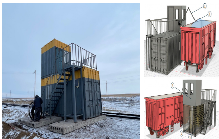
Рисунок 1 – Опытно-промышленная установка по обработке антиобледеняющей жидкостью бортов и днищ железнодорожных полувагонов в условиях разреза «Молодёжный»:
