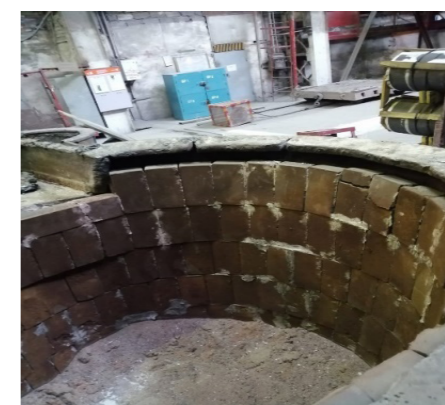
Рисунок 2 – Футеровка ковша для разлива феррохрома марок ФХ600-650
