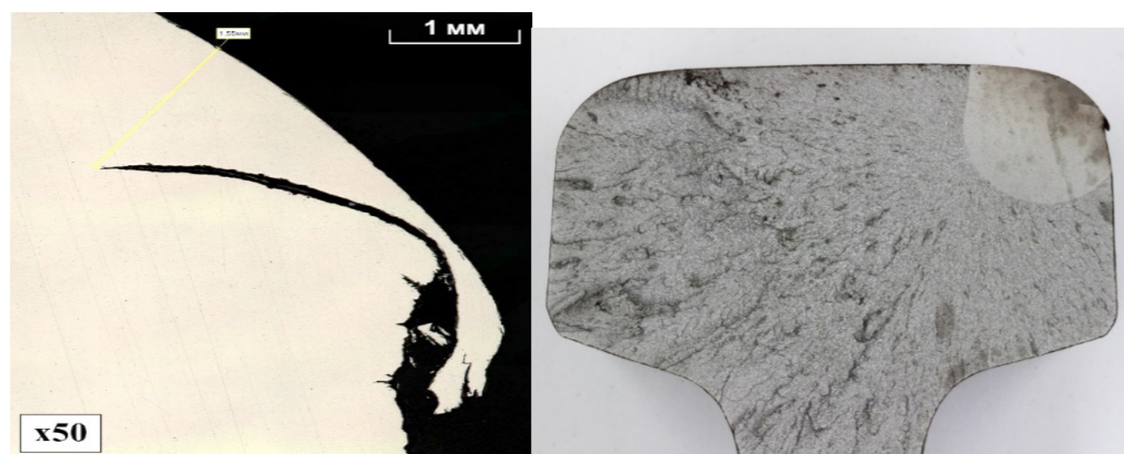
Сурет 4 – Төзімділік сынақтарынан кейінгі ескі рельстің сынуы
