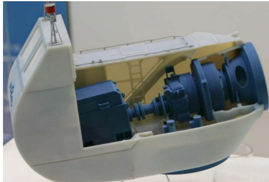
Сурет 1 – ЖЭҚ мультипликаторның жалпы көрінісі
