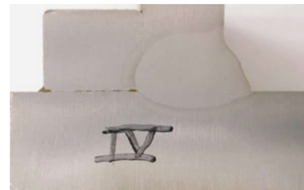
Рисунок 4 – Испытательный образец номер IV с толщиной стенки 10 мм
