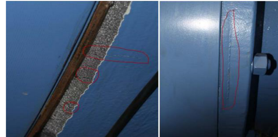
Сурет 2 – Редуктордың цилиндрлік сатысының корпусының жарылуы
