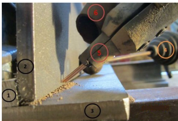
Рисунок 2 – Сварка под флюсом: 1 – квадратная опорная планка, 2 – стенка, 3 – пластина, 4 – устройство слежения за флюсом, 5 – рабочая часть, 6 – устройство подачи флюса.
