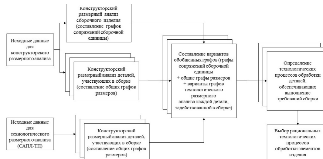
Рисунок 6 – Структура СТСТПМ, сформированная на основе связи между ТПП механообрабатывающего и сборочного производств
