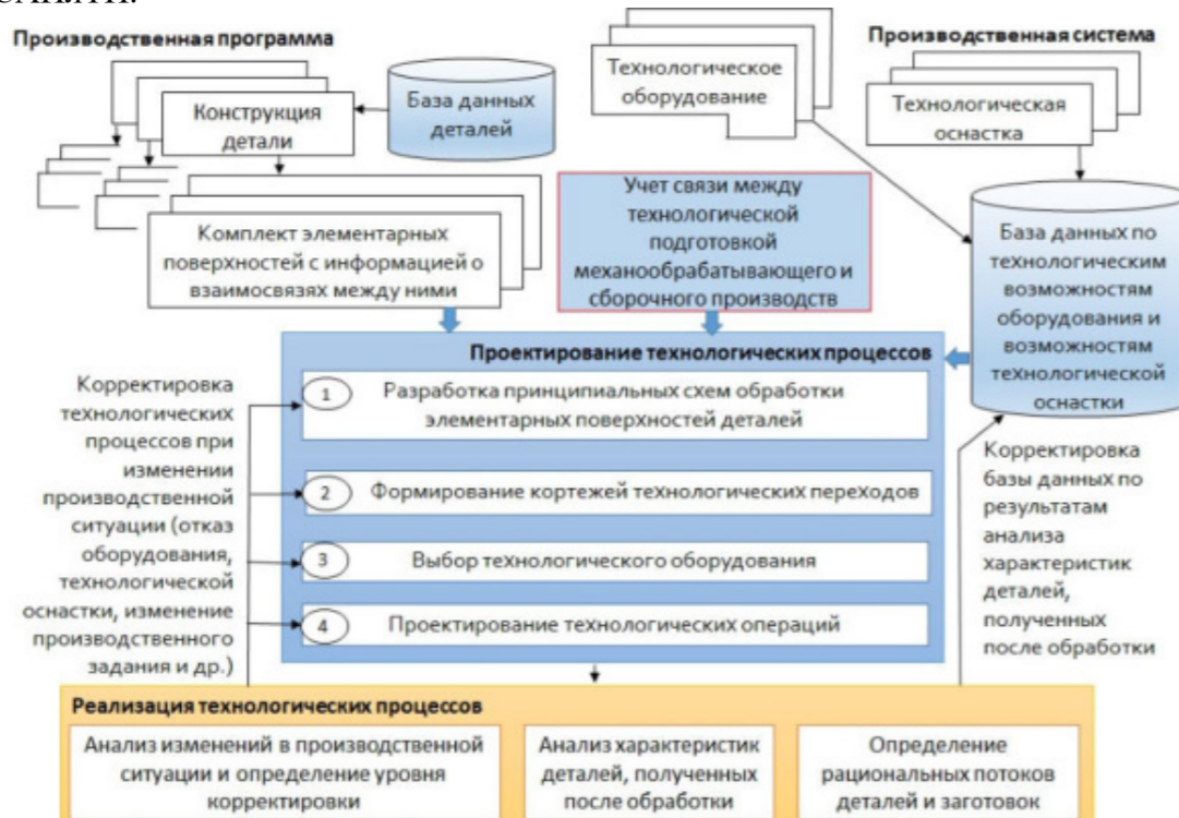
Рисунок 5 – Структура САПлТП и место, которое в ней занимает СТСТПМ
