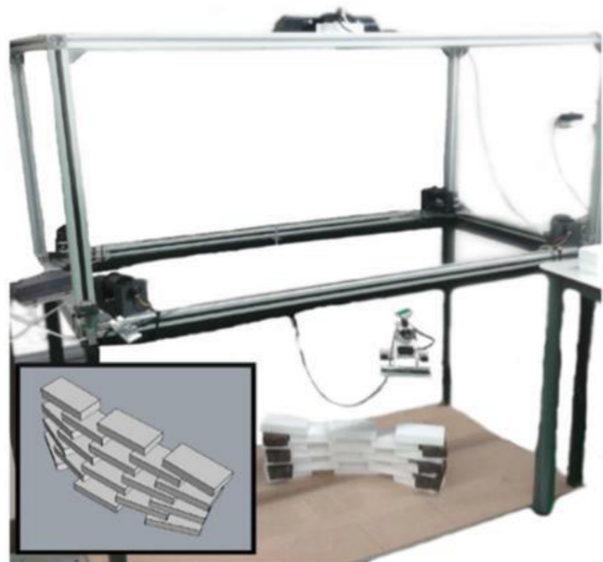
Рисунок 6 – ТТР SPIDERobot для автоматизированного строительства
