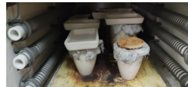
Рисунок 2 – Нагрев образцов до температуры 1200 °С
