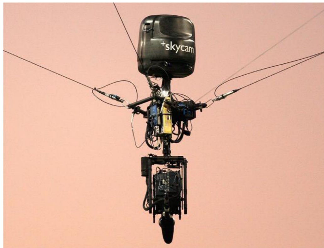
Рисунок 3 – Тросовый параллельный робот SkyCam
