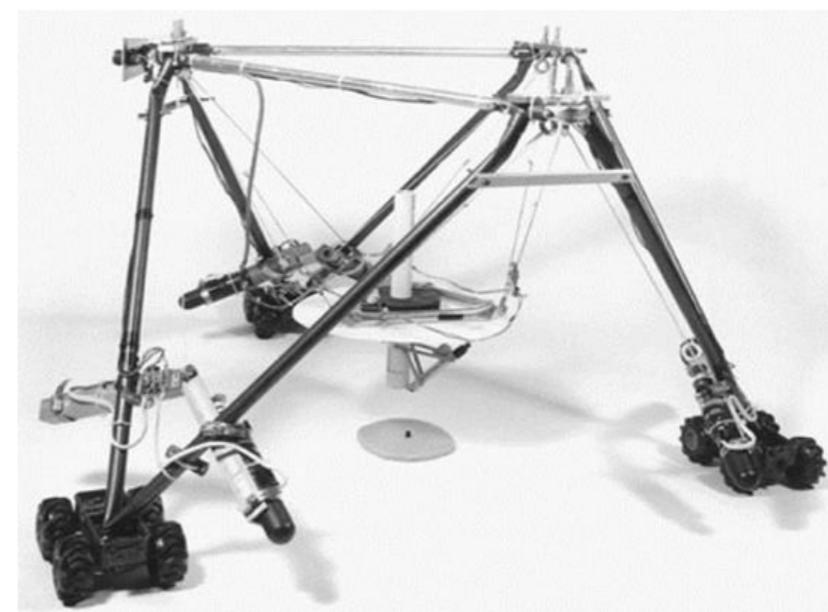
Рисунок 2 – Тросовый параллельный манипулятор RoboCrane
