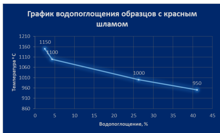
Рисунок 8 – График водопоглощения образцов с красным шламом
