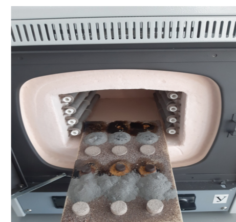
Рисунок 7 – Процесс обжига сырьевых материалов
