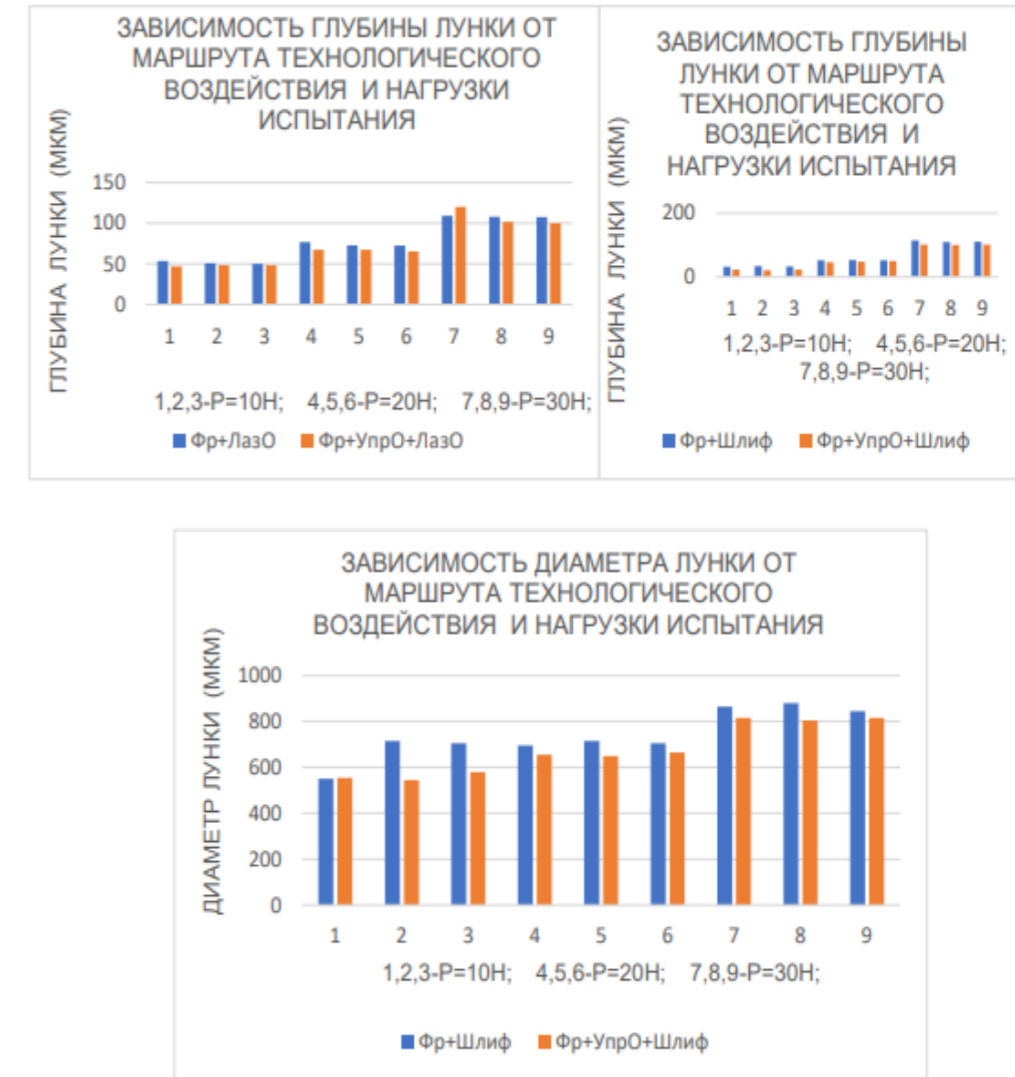
Рисунок 4 – Графики зависимостей значений глубины проникновения индентора в исследуемые участки поверхностного слоя с различным предварительным технологическим воздействием
