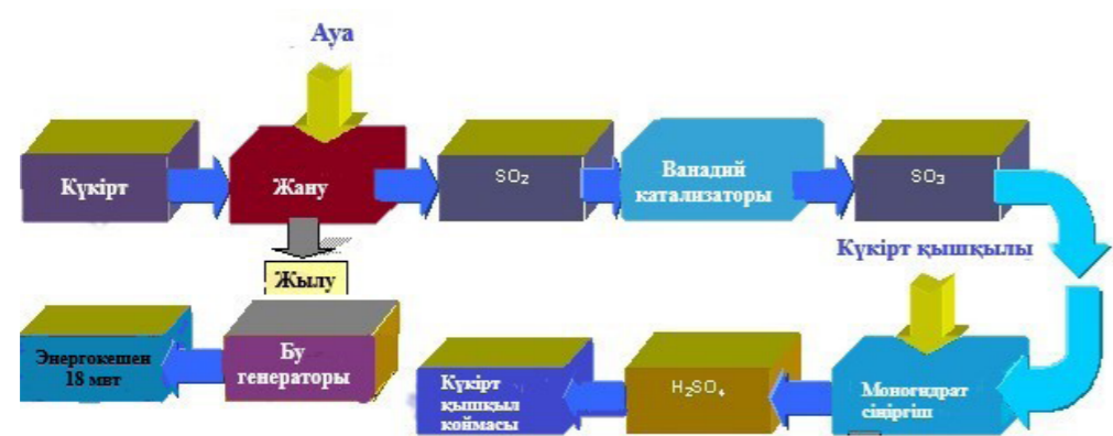
Сурет 1 – Күкірт қышқылын өндіру схемасы
