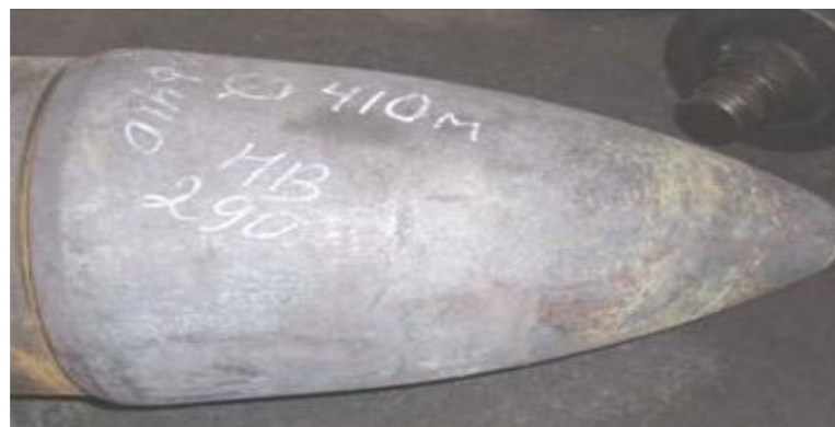
Сурет 2 – Көгілдір тормен және жұмыс бөлігінің бұзылу аймағы пайда болған тескіш құралбіліктің сыртқы көрінісі
