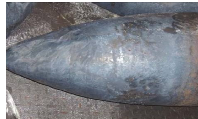
Сурет 1 – «Бұрме» жұмыс бөлігінің тозуға ұшыраған тескіш құралбіліктің сыртқы көрінісі
