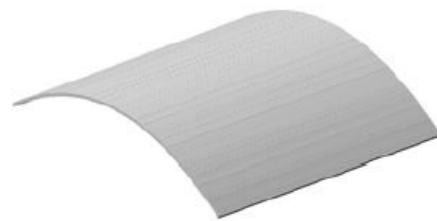
Рисунок 5 – Модель профиля упругого раздвижного элемента разработанная в программе «ПС ЛИРА»
