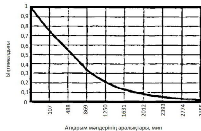
Сурет 3 – Конвейерлік таспалардың ақаусыз жұмыс уақытының P(t) ықтималдығын бөлудің дифференциалды функциясы
