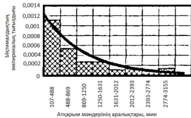
Сурет 2 – Гистограмма және конвейер таспаларының ақаусыз жұмыс уақытының экспоненциалды үлестірілу қисығы
