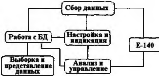
Рисунок 5 – Структура программного обеспечения системы
